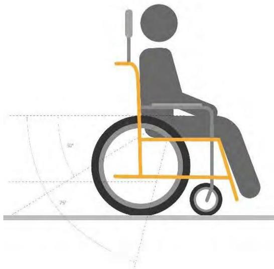
**Figura 3. Espacio requerido para la colocación de sillas de ruedas**
