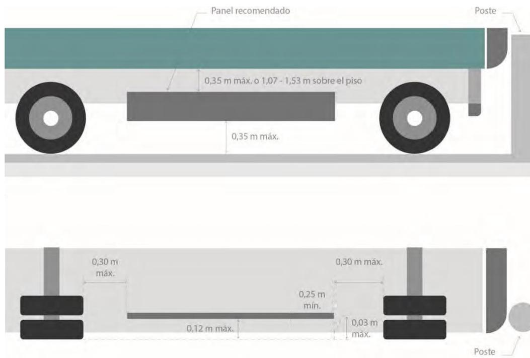
La parte inferior del salvaguarda debe estar a una altura de 0.35 m sobre la superficie de rodadura y la parte superior a 0.35 m de la plataforma del camión. Si no es posible cumplir con la cota en la parte superior del dispositivo, la parte superior de éste debe quedar entre 1.00 a 1.50 m sobre el nivel del arroyo vial.
